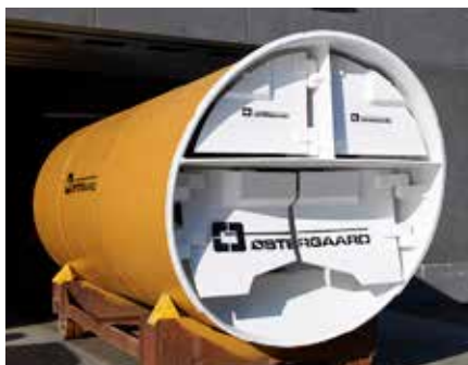
Foto 4: Tunnelfront med sandhylde og hydrauliske klapper
