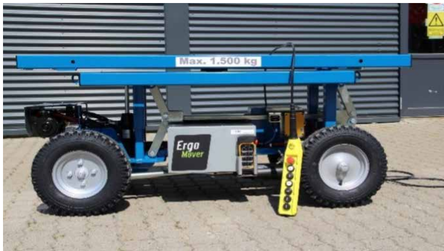
Foto 1: Fjernstyret el-vogn til transport kan anvendes til materiale
