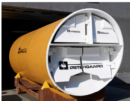
Foto 4: Tunnelfront med sandhylde og hydrauliske klapper
