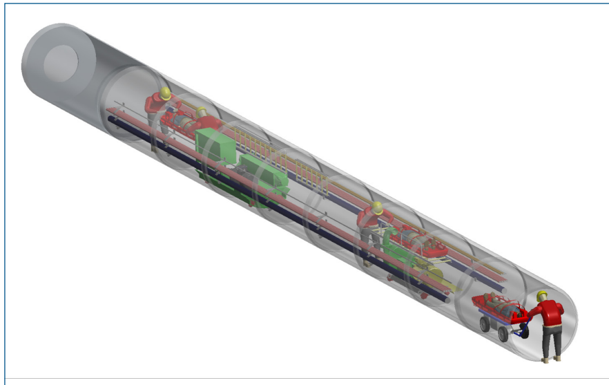
Figur 6: Forhindringer i tunnel, hvor bære skal transporteres over
